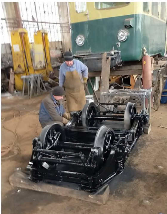
Vor einem Wagen der Wengernalp-Bahn ist der frisch bemalte Drehgestellrahmen zum Einbau bereit
