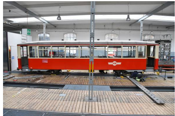
Anheben des Wagens auf Hilfsrädchen vor der Querverschiebung
