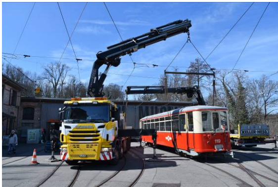
Der Wagen wird vor dem Anheben an beiden Enden unterfangen
