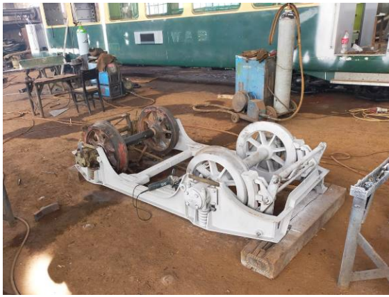
Die neuen Achsen sind eingebaut
