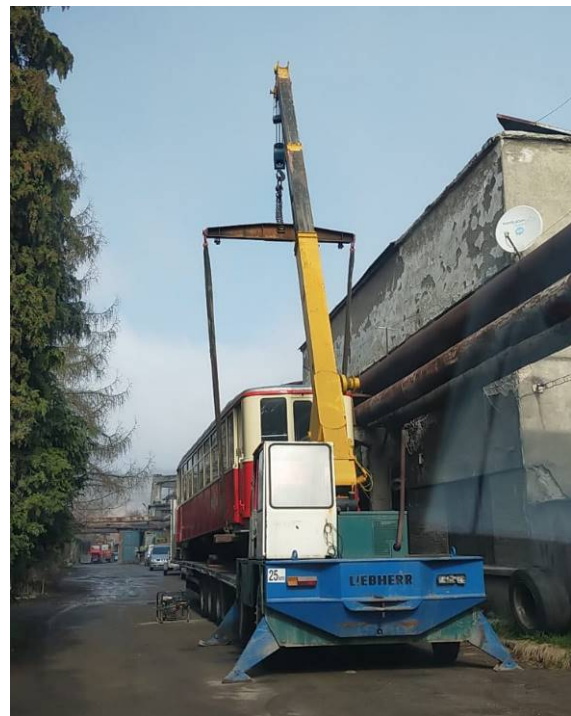
Der Wagen wird für den Einbau der Drehgestelle angehoben
