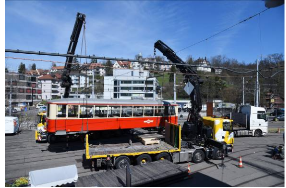
Der rumänische Sattelzug fährt unter den schwebenden Anhänger
