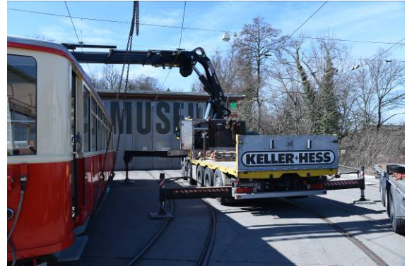
Die Seitenstützen verhindern das Kippen des Kranwagens
