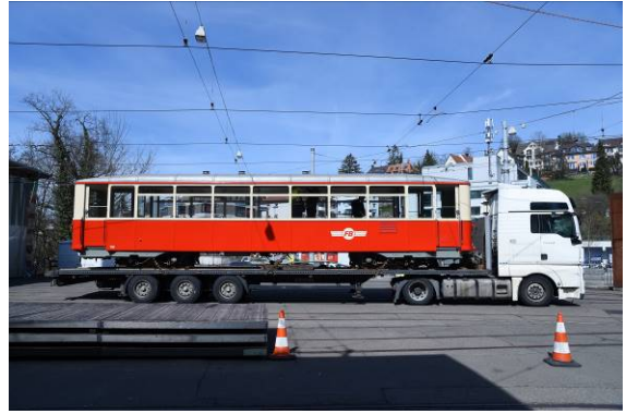
Die leichte Überhöhe der Ladung erforderte eine Ausnahmegewilligung der Strassenbehörden
