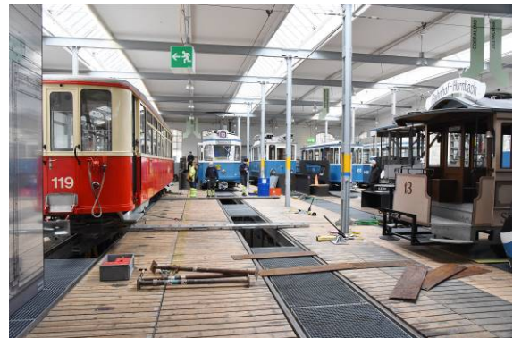
Bereit für die Verschiebung auf Metallbahnen mittels „Habegger“-Seilzügen
