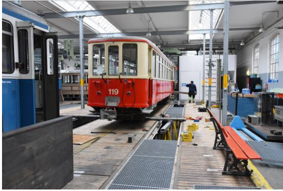
Höchst professionelle und präzise Handarbeit beim Verschieben über den nichttragenden, hölzernen Depotboden
