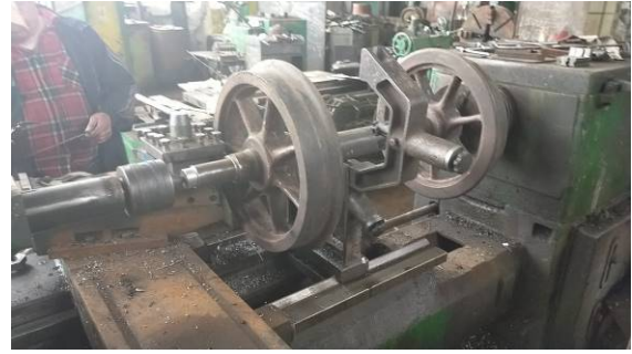
Eine Achse ist auf dem Drehbank in Bearbeitung
