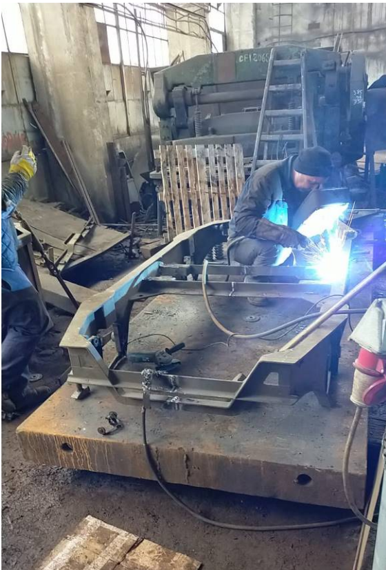
Der schmälere Rahmen wird wieder zusammengesweisst
