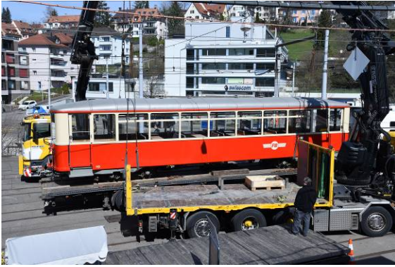
Der Wagen wird auf den Sattelaufleger abgesenkt
