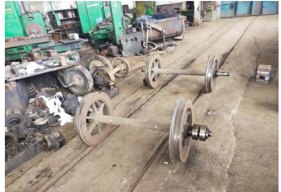
Die alten Meterspurachsen des „Lausanners“ sind ausgebaut
