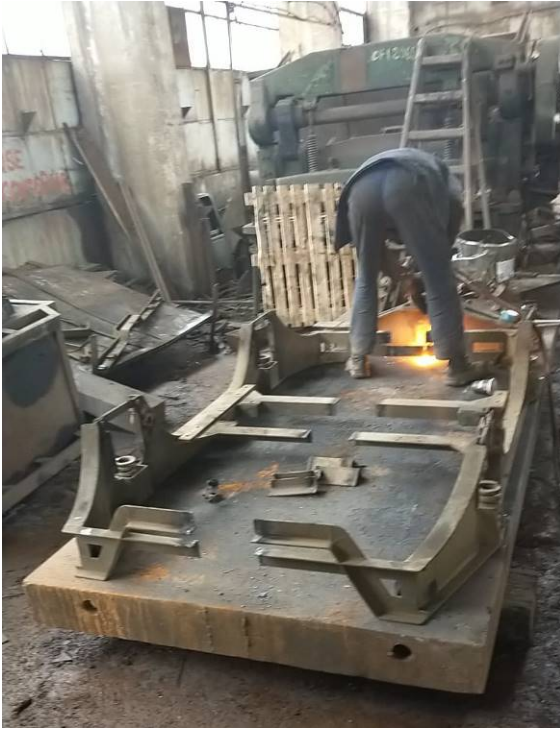
Die Breite des Drehgestellrahmen wird für die 750 mm-Spur verschmälert
