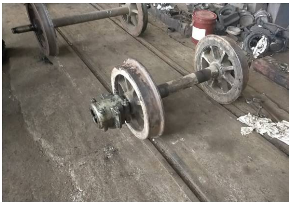
Die 760 cm-Spur-Achse steht vor der bisherigen Meterspur-Achse
