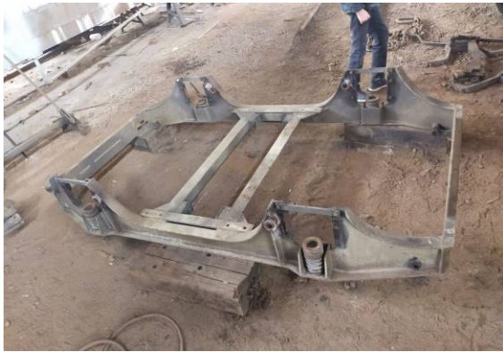
Ein Drehgestellrahmen ist ausgebaut
