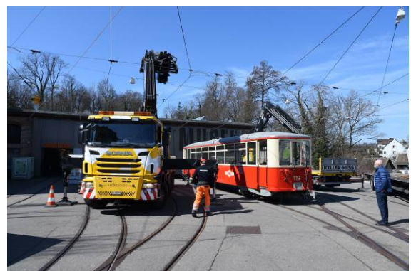
Zwei Autokräne sind nötig, um den fast 10 t schweren Anhänger zum Verlad anzuheben
