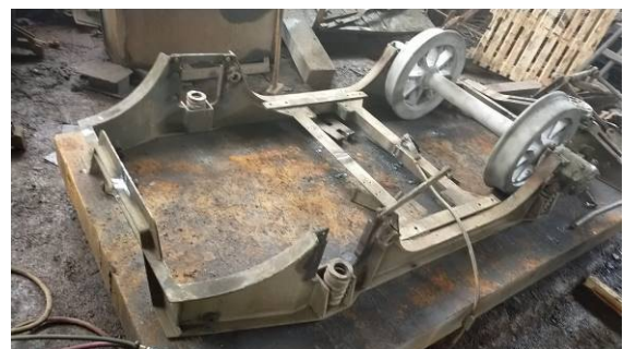
Der Rahmen steht für den Einbau der zweiten Achse bereit
