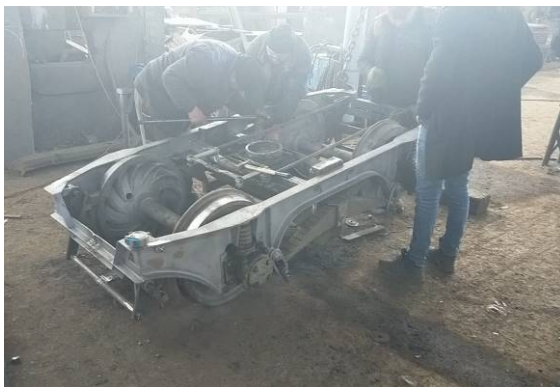
Ein Drehgestell in der Endmontage
