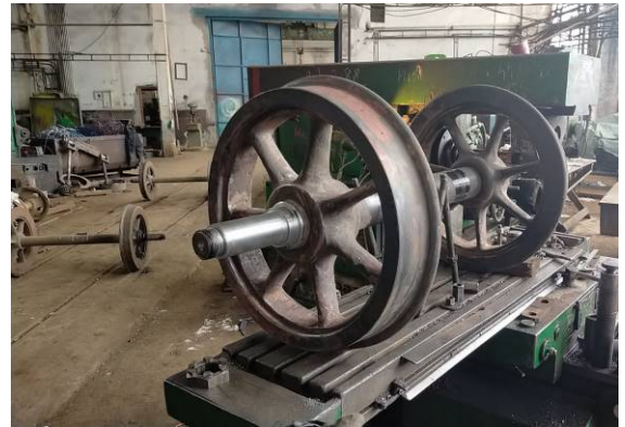
Die schmälere Achsen stehen zum Einbau bereit
