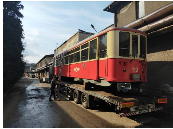
Der Forchbahn-Wagen steht zum Einbau der verschmälerten Drehgestelle bereit
