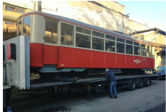
Der Wagen wird für den Einbau der beiden neuen Drehgestelle vorbereitet
