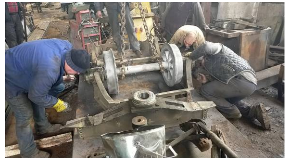
Eine erste neue Achse wird im verschmälerten Drehgestellrahmen eingebaut
