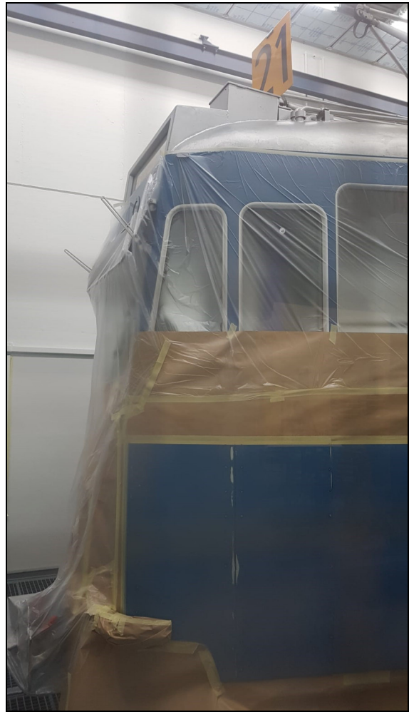
Abgedecktes "Kurbeli" zur Lackierung des Teilbereichs unterhalb der Zierlinie .
