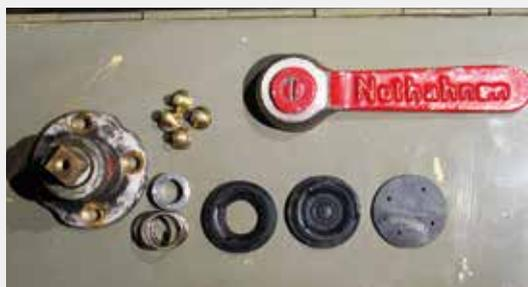
**Links 2 defekte, rechts 1 neue Membrane.**
